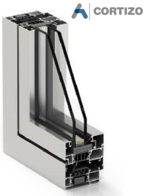
Sistema practicable de enorme éxito dentro del segmento de carpinterías económicas, sencillas y de altas prestaciones (ver resultados de ensayos). Profundidad del marco: 70 mm, de la hoja: 78 mm. Longitud poliamida: de 32 a 35 mm. Herraje: canal europeo de 21 mm.
