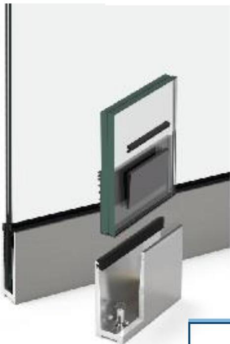
Sistema de barandilla minimalista que combina la estética más vanguardista con las máximas exigencias en seguridad. El llamado sistema "U" ha sido diseñado para alojar vidrio laminado de seguridad y puede ser instalado sobre el forjado, en el canto de forjado o enrasado (ver imagen de secciones).
