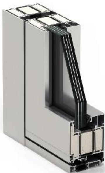
Sistema cortafuegos practicable que permite la sectorización y la evacuación de los usuarios al ofrecer 60 minutos de resistencia al fuego. Ensayo de resistencia al fuego y control de humo: CLASE EI 60 - C5.
