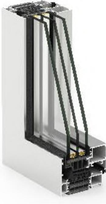
Sistema practicable de hoja oculta de alta gama, especialmente diseñado para obtener unas prestaciones inmejorables, especialmente en cuanto a transmitancia térmica (desde  $0,8 \text{ W/m}^2\cdot\text{K}$ ) y atenuación acústica (hasta 46 dB). Las reducidas dimensiones de esta serie (altura marco: 66 mm, nudo central 96 mm) maximizan la superficie acristalada y luminosidad interior.
