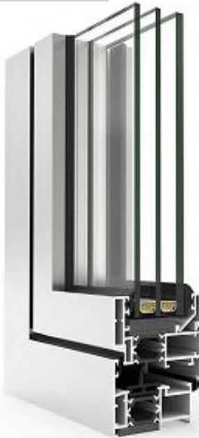
Este sistema practicable ofrece un destacado confort térmico y acústico, manteniendo una buena relación calidad-precio. Profundidad del marco: 60 mm, de la hoja: 68 mm. Longitud varilla poliamida: 24 mm. Herraje: canal europeo de 21 mm.
